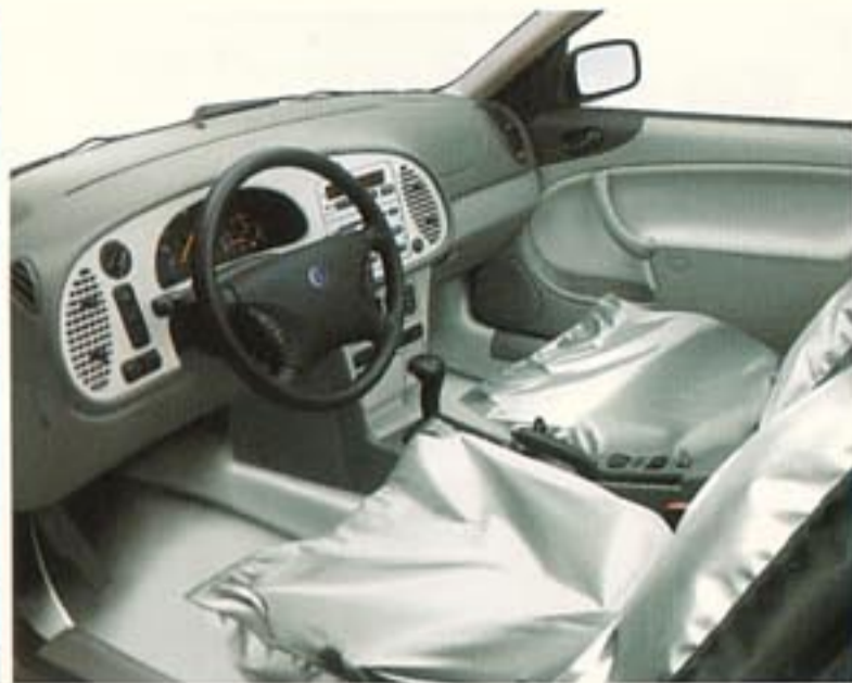
照明、ハイウエーブ。パンチングメタルを波型に曲げてある。サーブのシーティングコンセプトを依頼され、製作したもの
